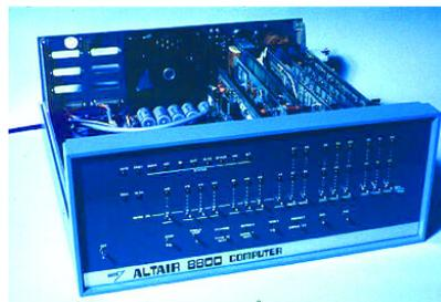
Der Altair 8800 bestand aus einem Klappgehäuse. An der Frontseite konnte man den Status des Rechners anhand von LEDs ersehen. Über diese wurden auch Ergebnisse ausgegeben. Eingaben machte man
